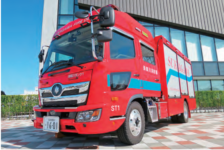
令和2年度配置 化学消防ポンプ自動車（Ⅱ型） 須賀川消防署 緊急消防援助隊登録車両
